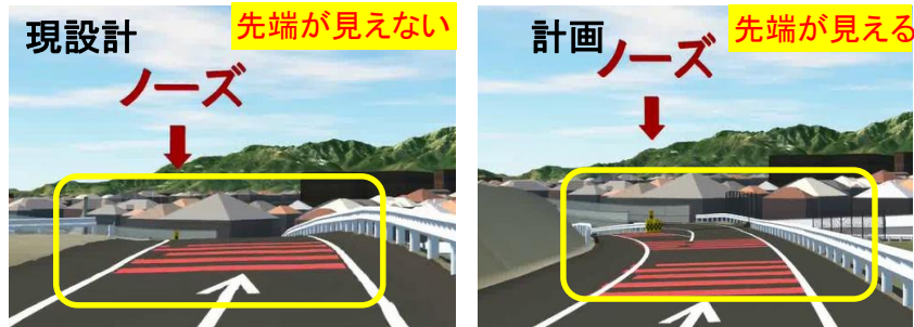
【土工区間】詳細度300:道路縦断変更時の ノーズ視距の確保状況を可視化。
