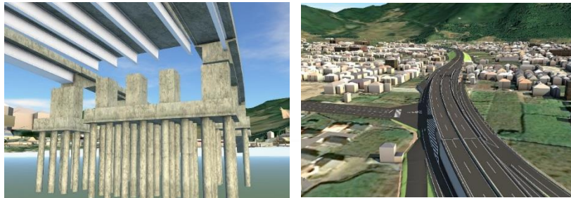
【橋梁区間】詳細度200：下部工モデルを作成（写真左） 完成イメージ・動画を説明会等で使用（写真右）
