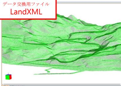
LandXMLより作成した地形モデルに電子納品されたボーリング交換用データをインポート
