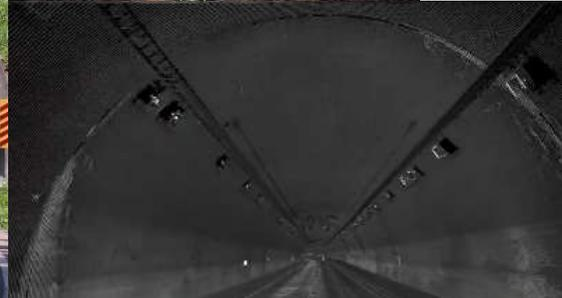
MMSで計測した点群でトンネル形状を3次的に把握し標準断面との比較から内空の変形モードを「見える化」
